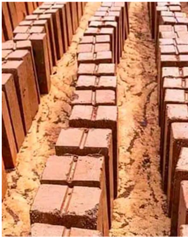
Bloques de construcción hechos con sargazo
